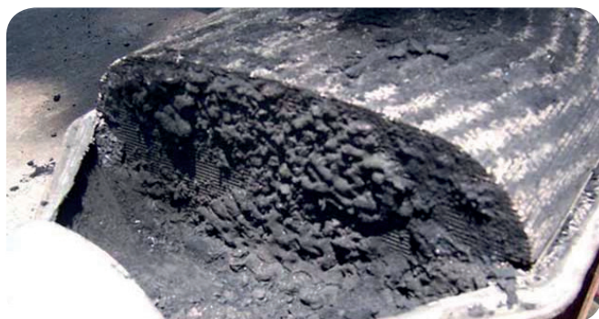
Smutsigt och igensatt dieselpartikelfilter.
