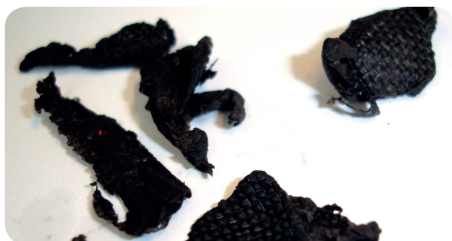
Intorkade dieselbakterier från dieselfilter.
