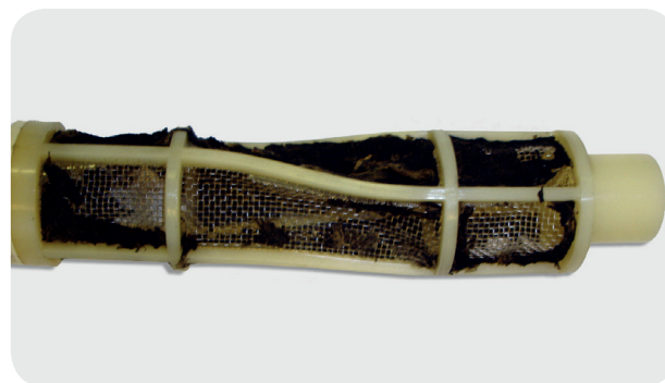
Dieselfilter innehållande dieselbakterier.
